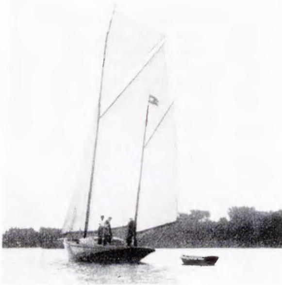
QUABBE VI : gaffelgetakelte Yawl aus Stahl von 13,25 m Länge und 120 qm Segelfläche mit 10-PS-Motor, Baujahr 1923
